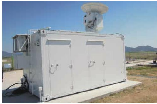
Ka-band millimeter wave cloud & fog radar Ka 波段毫米波云和雾雷达
